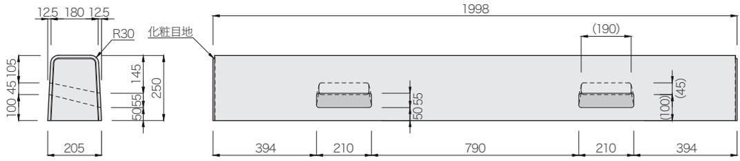
(注)水抜き寸法の( )内数は背面の水抜きの寸法を示す。
