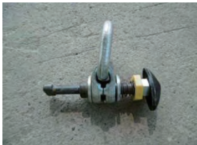
①専用吊具の取付け
